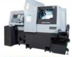
BW329ZJ 3つの独立した刃物台により、多彩なオーバーラップ加工が可能な自動旋盤
